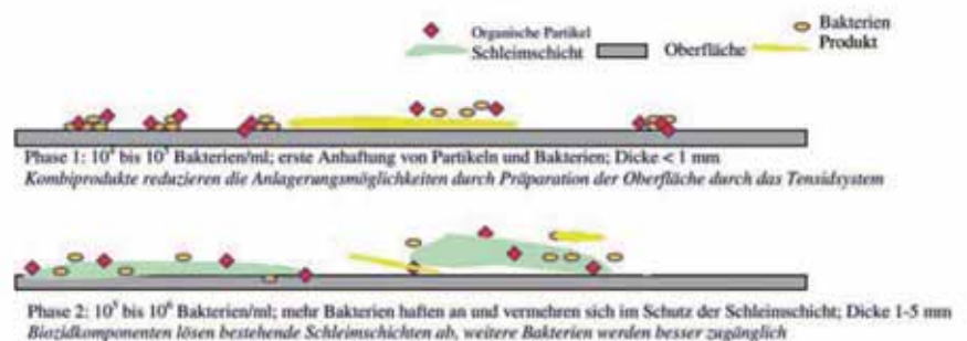
Abb. 1: Schematische Darstellung der Wirkungsweise moderner Kombinationsprodukte
